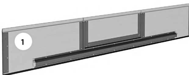
Калитка со стандартным порогом 145 мм
